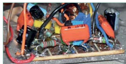
Bild 4. Diese Nahaufnahme zeigt, wie die Bauteile auf die Platine zu löten sind.
