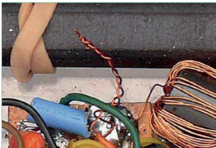
Bild 5. Zwei verdrehte Drähte bilden den „Trimmkondensator“ C7.
