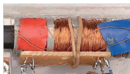
Bild 3. Spulen L1 und L2 werden auf einen Ferritstab mit etwa 8 mm Durchmesser und 90-100 mm Länge gewickelt.
